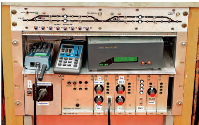
Herzstück der Anlage ist die ZIMO-Digitalzentrale MX1 2000 HS. Zur Handsteuerung sind mehrere ZIMO-Handregler unterschiedlicher Ausführung vorhanden.
