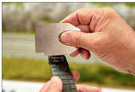
Mit einer sogenannten NMRA-Lehre wird das korrekte Radsatzinnenmaß aller Achsen überprüft und gegebenenfalls eingestellt.
