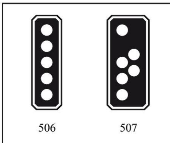
Die Signallinsen eines Hauptsignals sind in einer einzigen senkrechten Reihe angeordnet; allenfalls können die Linsen für Rot und Notrot aus Platzgründen leicht versetzt zur senkrechten Reihe stehen.
